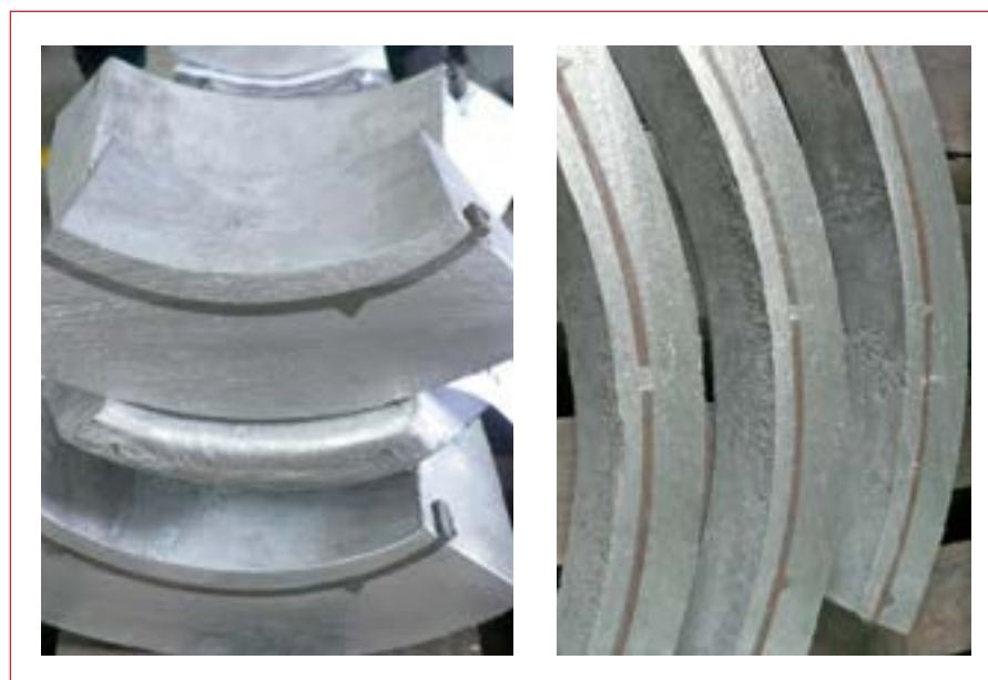
Рис. 1. Иллюстрация разрушающего метода контроля браслетного протектора
