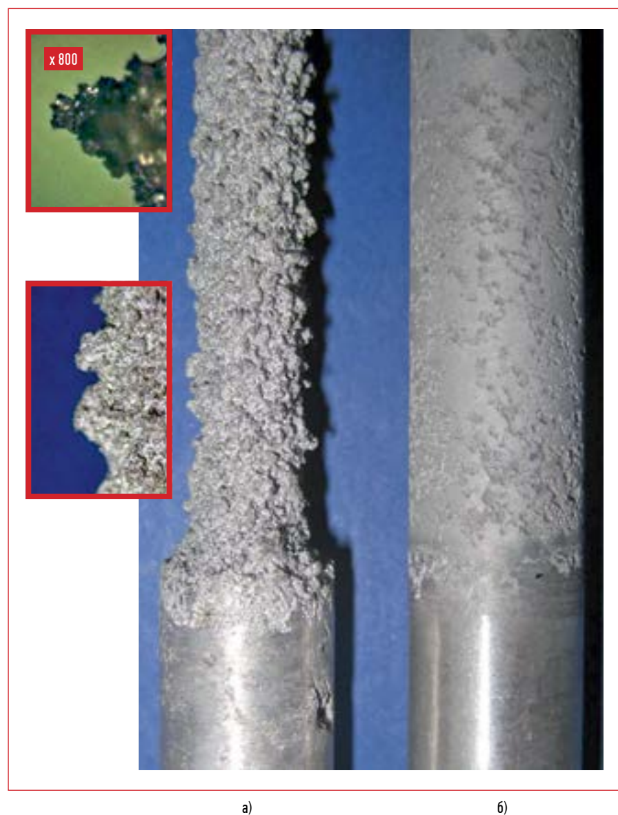
Рис. 2. Внешний вид образцов протекторных сплавов после лабораторных испытаний
