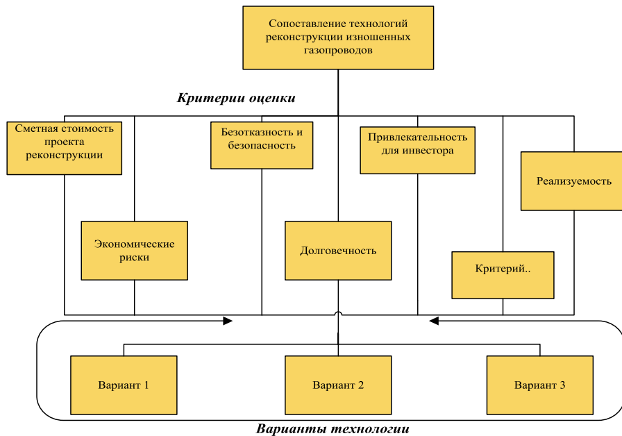
Рис. 2. Логическая схема анализа для сопоставления технологий реконструкции распределительных газопроводов
