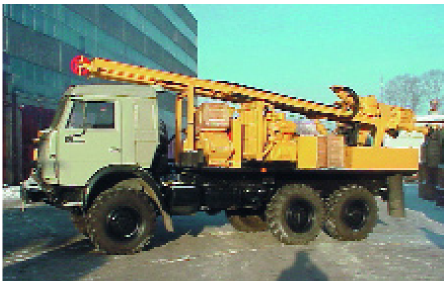
УРБ-2А2Д на шасси КамАЗ-43114
