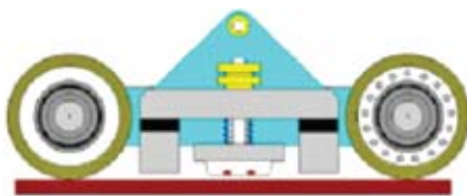
Рис. 3. Принцип устройства сканирующей части
