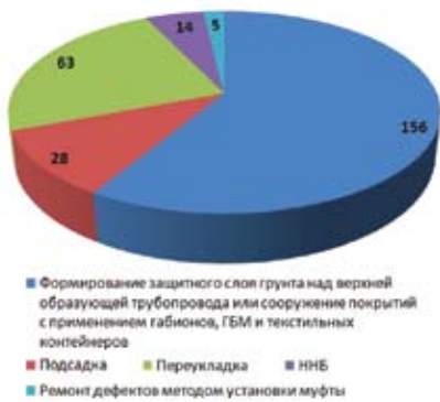
Рис. 1. Применение различных методов ремонта подводных переходов по дочерним обществам ООО «Газпром» в 2009–2011 гг.
