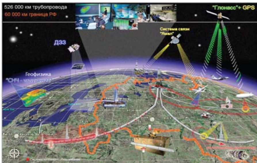
Рис. 3. Единая интеллектуальная система комплексного мониторинга функционирования нефтегазового комплекса [5]
