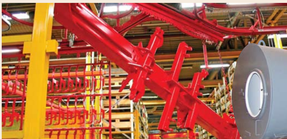
Для наружного покрытия используется система: ТЕКНОЦИНК 90 SE ТЕКНОДУР КОМБИ 3560-09
