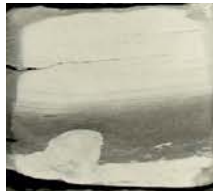
Рис. 6. Переслаивание песчаника тонко-мелкозернистого косослоистчатого и аргиллита алевритистого со следами биотурбации (на глубине 1494,63 м отмечается ход илоеда). Субфация предфронтальной зоны пляжа. Ем-Еговская площадь, скв. 30034р, пласт ВК 1 , инт. 1494,57–1494,65 м
