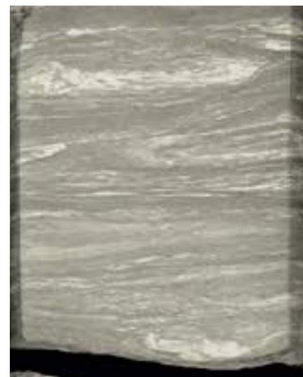
Рис. 8. Текстура оплывания, образованная в результате перемещения пластичного слоистого песчано-глинистого осадка. В средней и нижней частях образца – песчаные «роллы» (от англ. roll – заворот), плавающие в глинистом осадке. В песчаных прослоях видна тончайшая прерывистая косая слоистость, обусловленная глинистым материалом и углистым детритом. Ем-Еговская площадь, скв. 30034р, пласт ВК 2 , инт. 1510,40–1510,55 м
