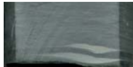
Рис. 10. Аргиллит алевроитовый градационно-слоистый. Развита тонкие линзы песчаника. Фация дальней зоны пляжа (альтернативная обстановка – центральная часть крупной изолированной лагуны). Ем-Еговская площадь, скв. 3665, пласт ВК 2 , инт. 1462,23–1462,27 м Fig. 10. Gradually stratified silt argillite. Thin lenses of sandstone are developed. Facies of the farthest shore zone (alternative circumstance – central part of a large isolated lagoon). Yem-Yegovskaya area, well 3665, formation ВК 2 , interval is 1,462.23–1,462.27 m
