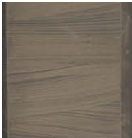
Рис. 4. Песчаник мелкозернистый нефтенасыщенный с разнонаправленной слоистостью ряби волнения. Субфация нижнего пляжа. Ем-Еговская площадь, скв. 1891, куст 159, пласт ВК 1 , инт. 1427,30–1427,60 м
