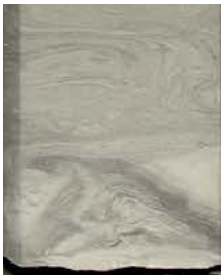
Рис. 7. Текстура конседиментационной деформации, развитая во время отложения алевритопесчаного осадка (конволютная слоистость, возможно оползание). Ем-Еговская площадь, скв. 30034р, пласт ВК 1 , инт. 1496,65–1496,80 м
