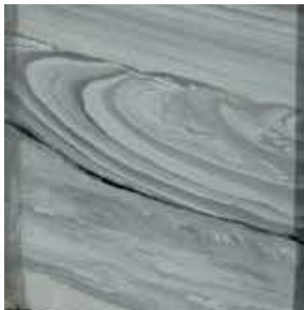
Рис. 9. Переслаивание градационное аргиллита и песчаника тонкозернистого алевроитового. Фиксируется текстура нарушения слоистости – «песчаные роллы». Фация нижней части переходной зоны пляжа. Ем-Еговская площадь, скв. 3682, пласт ВК 1 , инт. 1471,10–1471,25 м Fig. 9. Gradual alteration of argillite and fine-grained silt sandstone. Disturbed stratification texture is fixed as «sandy rolls». Facies of the lower part of the shore transitional zone. Yem-Yegovskaya area, well 3682, formation ВК 1 , interval is 1,471.10–1,471.25 m
