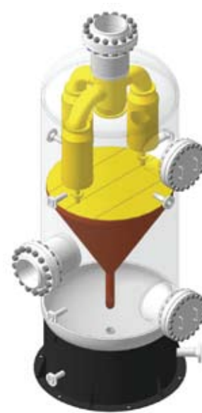
Рис. 2. Пылеуловитель проекта ГП 105 после проведения ремонта по указанной методике
