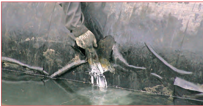
Рис. 1. Общий вид изоляционного покрытия и состояние металла на участках подпленочной коррозии (объекты – магистральные газопроводы, газопроводы-отводы, трубопроводы ПХГ)
