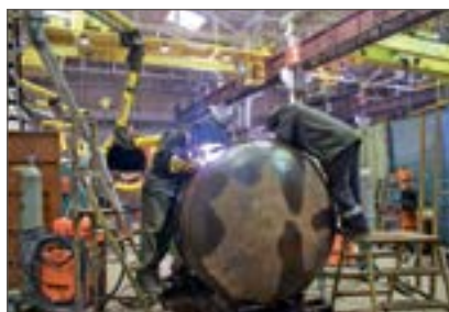
Рис. 2. Сварка корневого слоя шва одновременно двумя сварщиками по переменному зазору (1,5–5,0 мм)
