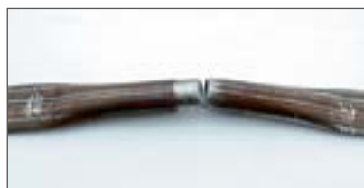
Рис. 8. Испытания на растяжение трубчатого образца КСС DN 20
