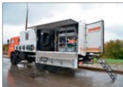
Рис. 3. Передвижной сварочный комплекс на шасси автомобиля КАМАЗ 43118-46
