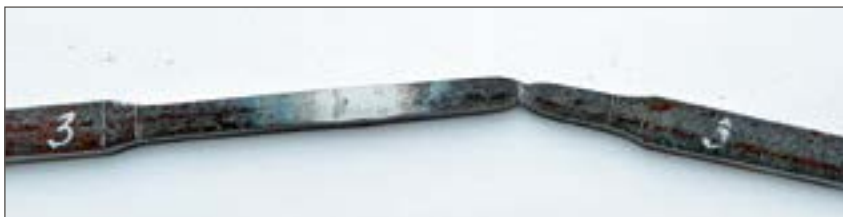
Рис. 9. Испытания на растяжение сегментного образца КСС DN 80
