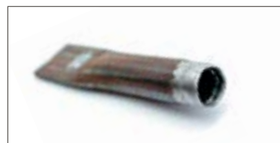
Рис. 8. Испытания на растяжение трубчатого образца КСС DN 20
