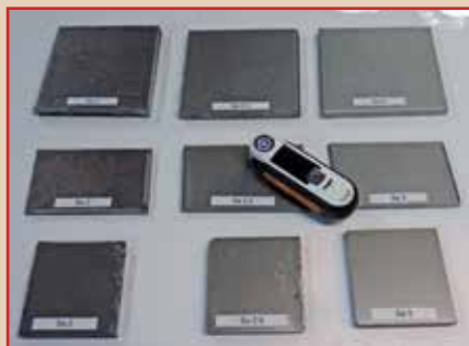
Рис. Калибровка прибора для контроля степени чистоты на эталонных образцах
