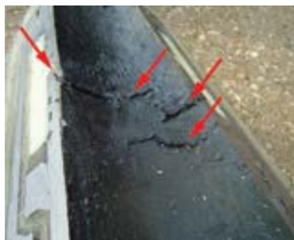
Фото 2. Разрушение внутреннего стеклопластикового вкладыша
