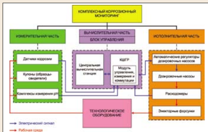
Рис.1. Функциональная схема системы коррозионного мониторинга установки АВТ
