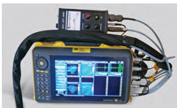
Рис. 1. Изображение электронного блока и сканера системы HARFANG VEO
