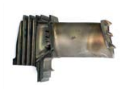
Рис. 5. Лопатка первой ступени турбины ГТУ SGT-600 «Балтика-25», подвергнутая реинжинирингу
