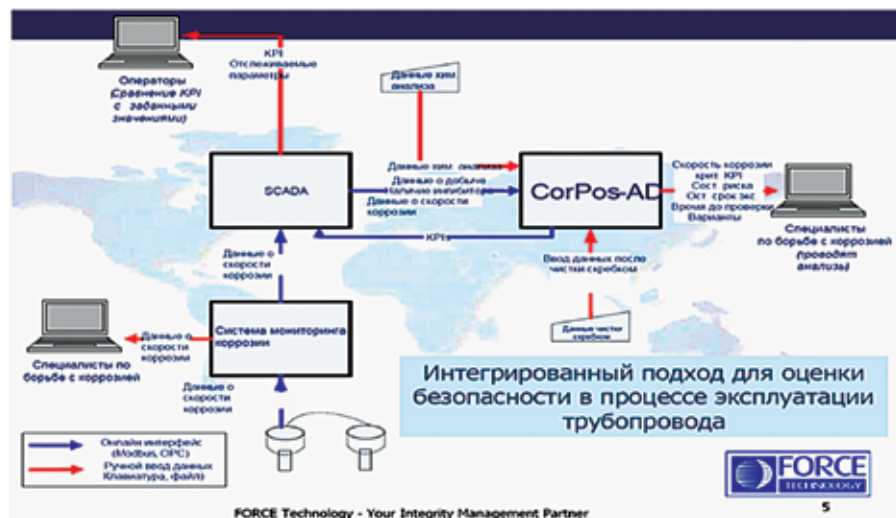
Рис. 7. CorPos-AD в онлайн SCADA-варианте
