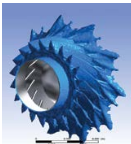
Рис. 3. Гидравлическая модель венца с косозубым симметричным вооружением
