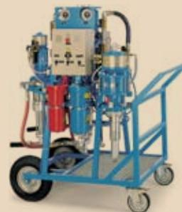
живаются на крупном дисплее, предусмотрено автоматическое отключение следящей системой за давлением и соотношением смешивания, а также есть система слежения уровня материала в напорных емкостях с автоматическим наполнением.
