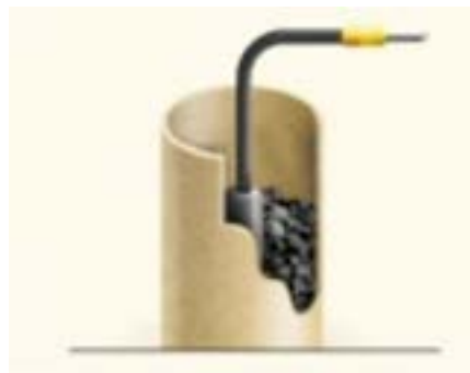
Рис. 1. Фрагмент электрода с кабелем в картонном тубусе, заполненном коксовой засыпкой. Узел контакта герметизирован термоусаживаемой трубкой
