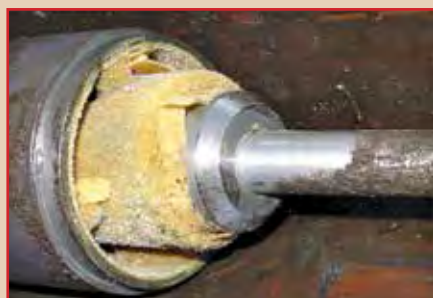
Фото 1. Отложения гипса в оборудовании добывающих скважин
