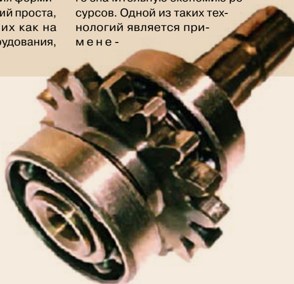
Рис. 1. Шестерня после испытаний в режиме «сухого» трения штатного масла ТСЗп-8 + «СУПЕР-ФОРУМ»
