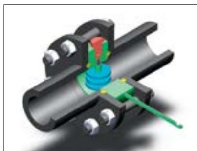
Рис. 5. Межфланцевый узел контроля скорости коррозии
