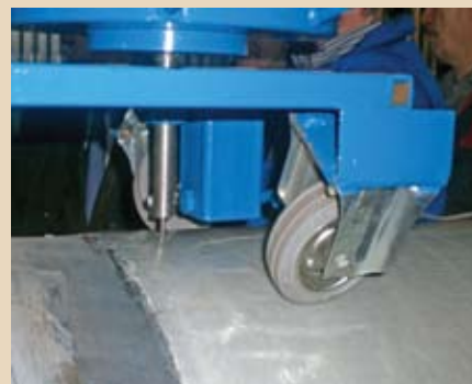
Фото 3–4. Фрагменты испытаний на стойкость к прорезанию защитного покрытия Fibertech с использованием оборудования ЗАО «Анкорт»
