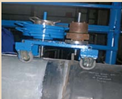
Фото 3–4. Фрагменты испытаний на стойкость к прорезанию защитного покрытия Fibertech с использованием оборудования ЗАО «Анкорт»
