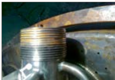
Рис. 3. Разрушение резьбы патрубка подвода топлива
