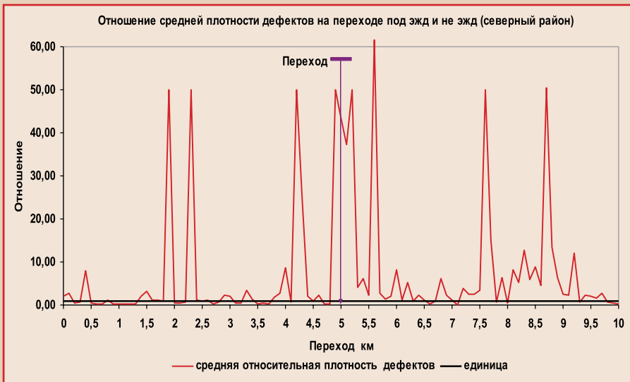
Рис. 6. Отношение средней плотности дефектов переходов под ЭЖД к плотности дефектов переходов НЖД
