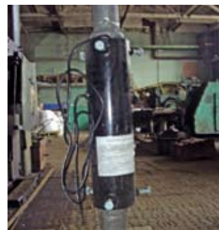
Рис. 4. Сцепное устройство ГОАЗ для монтажа заземлителей в полевых условиях
