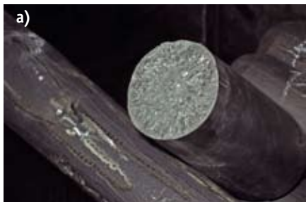
Рис. 5а. Равномерная фрактограмма заготовки полученной по кокельной технологии
