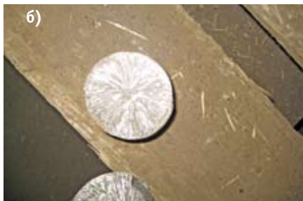
Рис. 5б. Радиальная фрактограмма заготовки полученной по старой технологии
