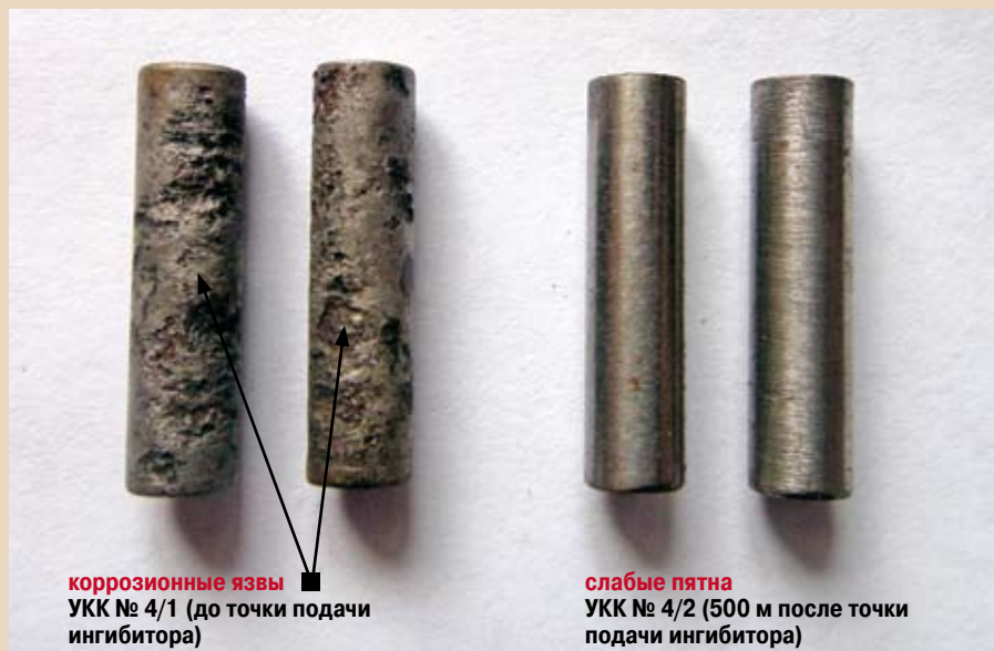
Рис. 2. Внешний вид образцов из УКК, установленных на низконапорном водоводе «УПСВ-0413 – КНС-0404», после 8 месяцев экспозиции в пластовой воде, сбрасываемой с УПСВ (2009–2010 гг., ингибитор коррозии – Сонкор-9801, дозировка – 40 г/м 3 )
