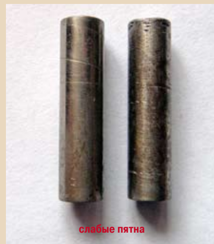
Рис. 4. Вид образцов из УКК, установленных на пониженном участке трассы нефтепровода «ДНС-0410 – ДНС-0412», после восьми месяцев экспозиции в водо-нефтяной эмульсии с содержанием воды 80% (2009 г., ингибитор коррозии – Сонкор-9801)
