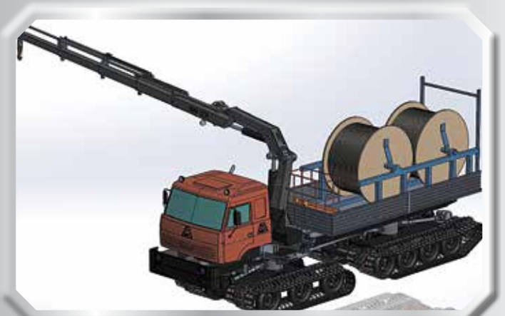
ТСК-КМУ Кабель укладчик
