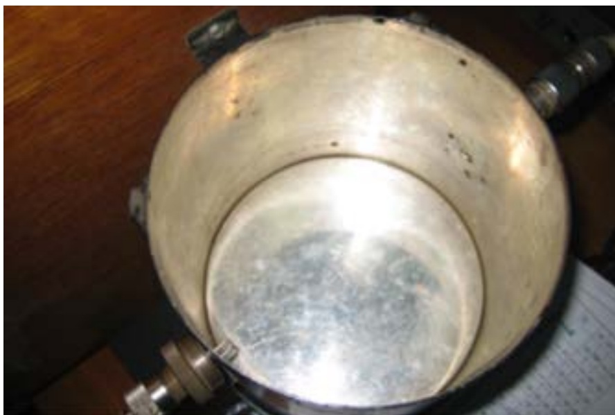
Рис. 4. Внешний вид исследуемого резонатора с колебаниями H_{011} и H_{013}
