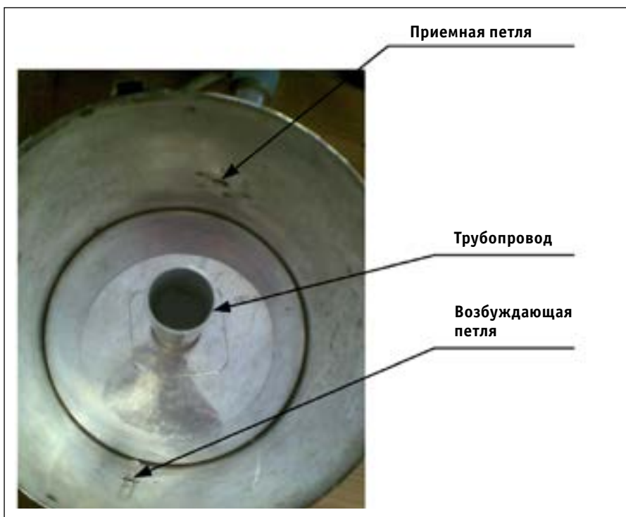
Рис. 7. Внутренний объем резонатора с трубопроводом на оси
