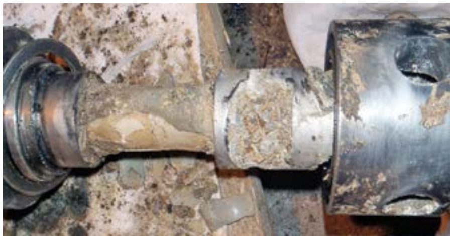
Рис. 2. Солеотложения в насосе высокого давления системы ППД платформы ПА-Б Fig. 2. Scaling the high-pressure pump of FPM system of PA-B platform
