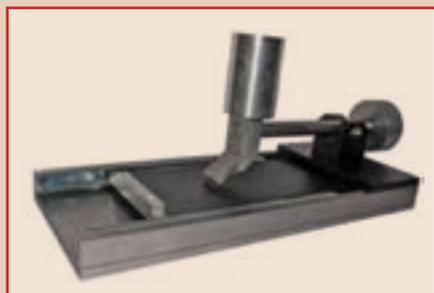
**Фото.** Прибор для определения устойчивости покрытия к царапанию
