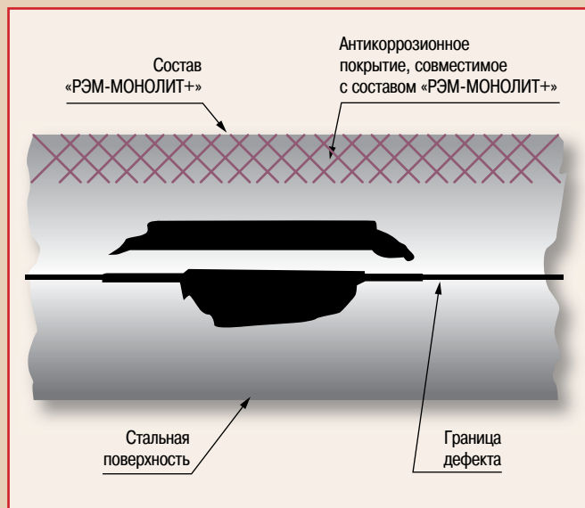
Рис. 2. Схема ремонта несквозного дефекта металла (язва, каверна)
