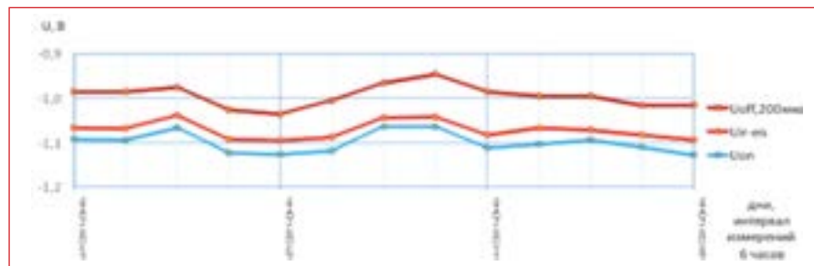
Рис. 6. Данные СКМ на одном из участков магистрального трубопровода, оборудованного подсистемой коррозионного мониторинга ПКМ-ТСТ
