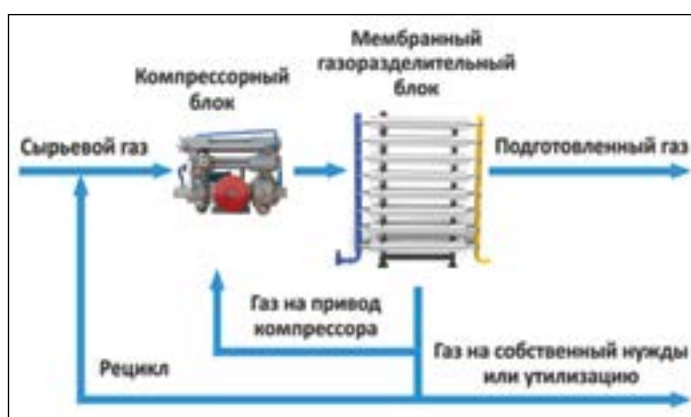
Рис. 2. Двухступенчатая схема подготовки газа с рециклом
