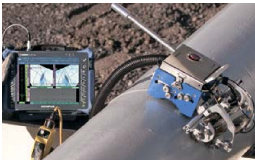
Рис. 1. Дефектоскоп OmniScan MX2 и сканер WeldROVER
