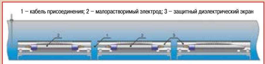
Рис. Схема расположения анодных заземлителей «Менделеевец»-МРГ внутри трубопровода
