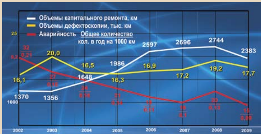
Рис. 1. Динамика аварийности, объемов работ по дефектоскопии, капитальному ремонту
