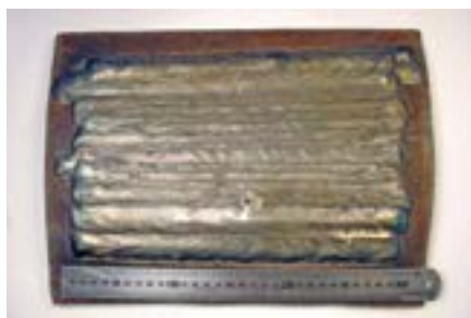
Рис. 1. Зона с ремонтной наплавкой (глубина выборки – 3 мм)
