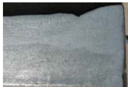
Рис. 2. Макрошлиф образца, наплавленного сваркой под флюсом, x2
