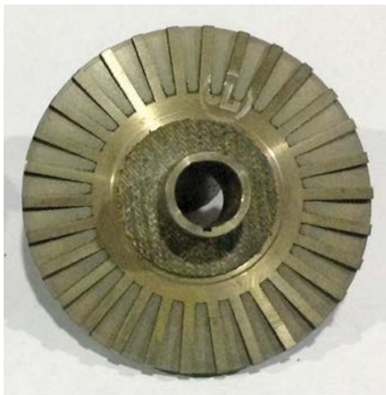
Рис. 4. Разгружающие лопасти открытого колеса [12]
