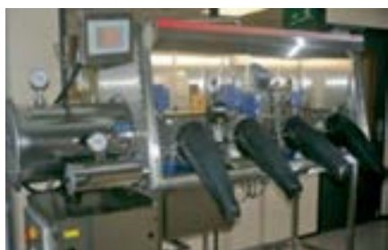
Рис. 1. Стерильная камера Jacomex GP T-4, используемая для замеров термической стабильности образца
