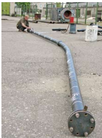
Рис. 6. Плеть с соединением RJ после испытаний на внутреннее давление с изгибом
