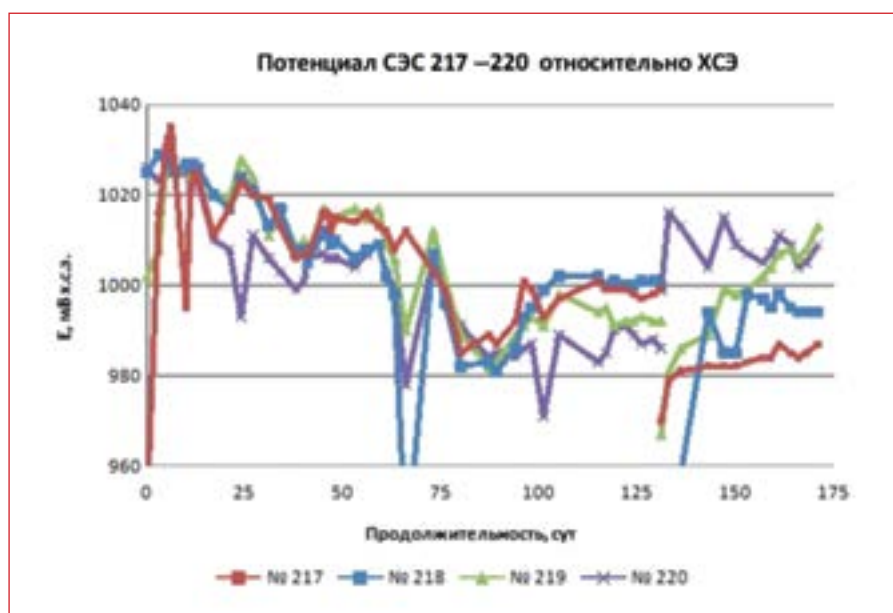
Рис. 7. Результаты экспозиции электродов СЭС-2 в течение 175 сут
