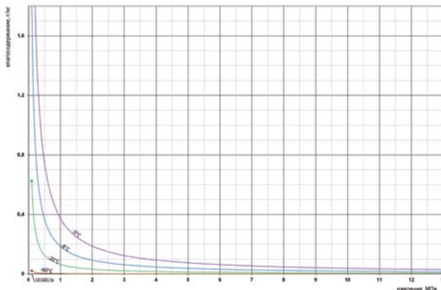
Рис. 1. Зависимость влагосодержания воздуха при его 100%-ной относительной влажности от давления при различных температурах
