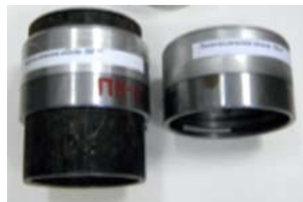
Рис. 2. Внешний вид биметаллических колец ПК-6", (на трубе Ø168 мм) позволяющих создавать участки «гарантированного сцепления» в сочетании с пеноцементной технологией.
