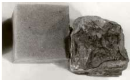
Рис. 1. Внешний вид плоскости излома образцов портландцементного камня ПЦТ-50 после извлечения из действующей скважины (справа), и контрольных, хранившихся в лабораторных условиях (слева). Виден черный фронт коррозии. Размеры: 40x40x160 мм.
