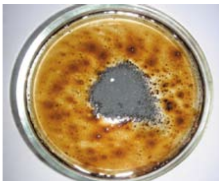
Рис. 5. Нанесение сухой смеси ГВС на загрязненную нефтью водную поверхность.
