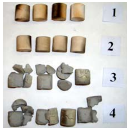
Рис. 3. Образцы 1-4 цементного камня Ø18мм после 10 циклов (с 20°C до 320°C) термического воздействия. Где: рецептуры 1–2 предлагаемые к внедрению и разрабатываемые, 3–4 проектные.
