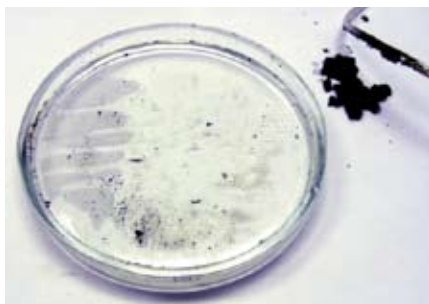
Рис. 7. Удаление заблокированной нефти механическим способом с водной поверхности. Поверхность без пленки нефти.
