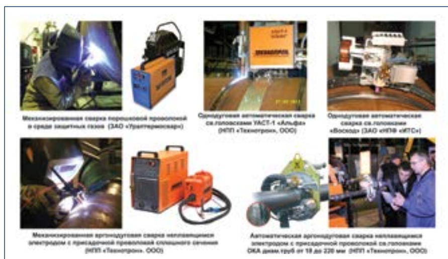
Рис. 7. Технологии механизированной, автоматической и аргодуговой сварки с применением сварочного оборудования отечественного производства
