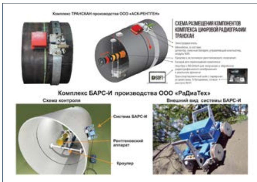
Рис. 6. Отечественные системы цифрового радиографического контроля качества кольцевых сварных соединений
