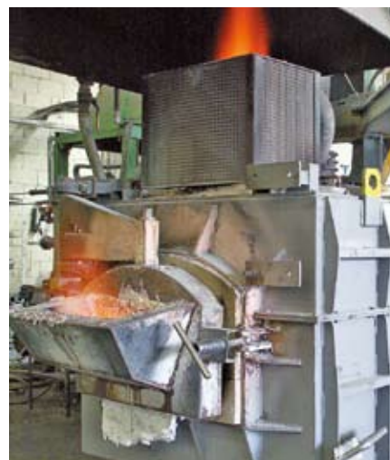
Рис. 2. Подготовка сплава GALSi13 марки KSi13 к литью в 10-тонной печи
