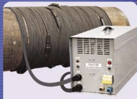
Установка КУДИН-200А для размагничивания труб
