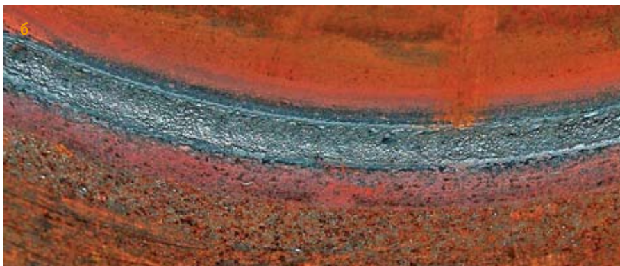
Рис. 6. Внешний вид шва (а) и вид шва изнутри трубы (б), выполненного автоматической аргонодуговой сваркой неплавящимся электродом в аргоне
