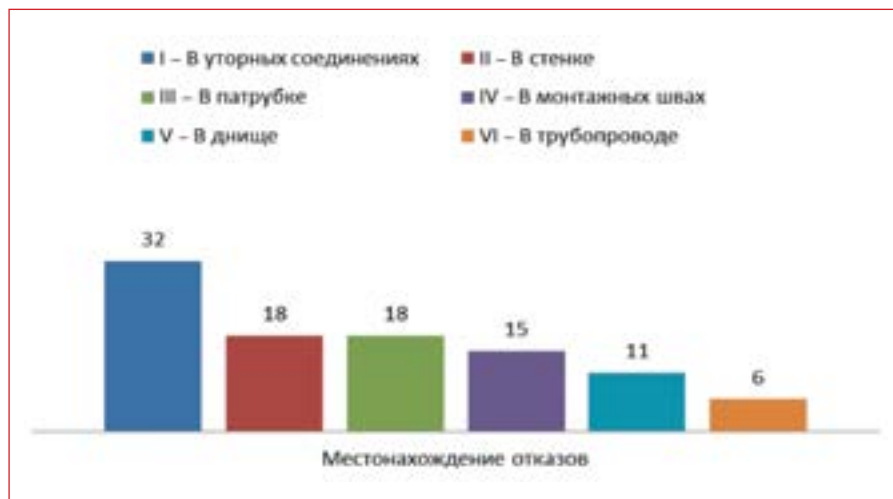
Рис. 2. Процентное соотношение дефектов в сварных соединениях РВС:
