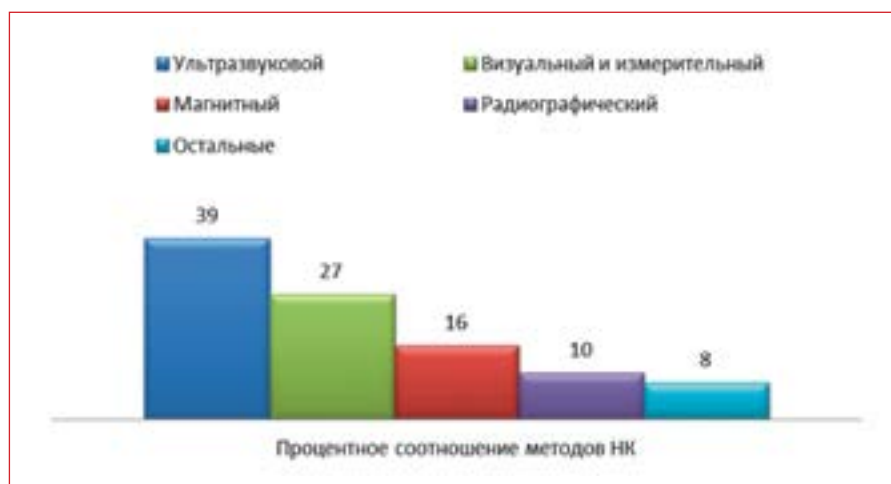
Рис. 1. Процентное соотношение применяемых методов НК при диагностике вертикальных стальных резервуаров
