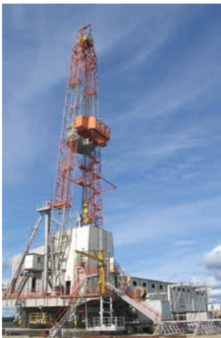
Модернизированная БУ «Уралмаш» 3000 ЭУК 1М зав. № 14404, находится в эксплуатации на Малобалыкском м/р, к. №630 – осуществляет работу на Заказчика ООО «РН-Юганскнефтегаз»
